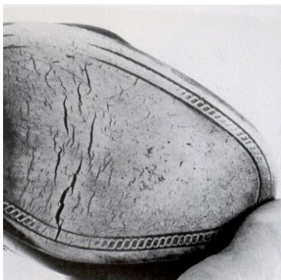
Godkendt reklamation. PVC-sål sandsynligvis lavet i et for hårdt materiale og er derefter knækket ved almindeligt brug.
