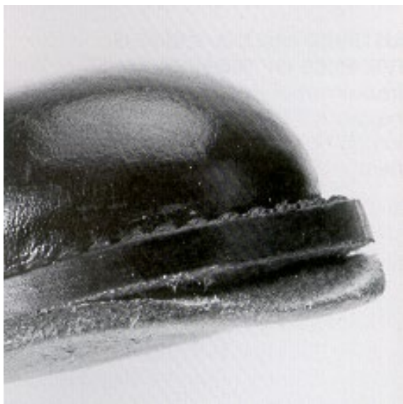
Godkendt reklamation. Sålen er tydeligvis ikke slidt eller har været udsat for overlast. Reklamationen klares let med lidt lim.
