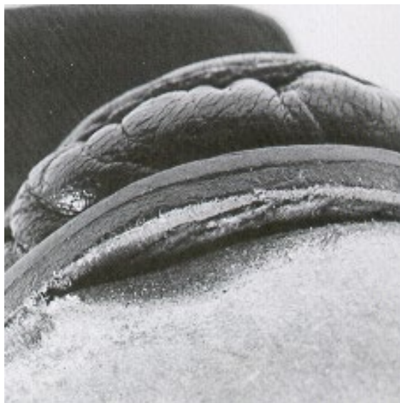
Afvist reklamation. Sålen er slidt tynd, og slipper derfor skaftet.
