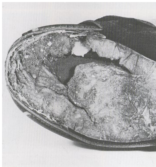
Godkendt reklamation. For tidlig nedbrydelse af bindsål, hvilket har medført revner og huller. Dette er en reklamation, som er umulig at lave.
