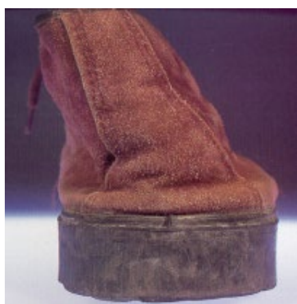
Godkendt reklamation. Hælkappen er for blød, og det har medført, at skoen er faldet sammen.
