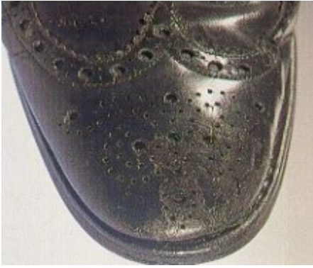
Godkendt reklamation. Finishen på skaftet er begyndt at falde af. Denne reklamation kan ikke repareres.
