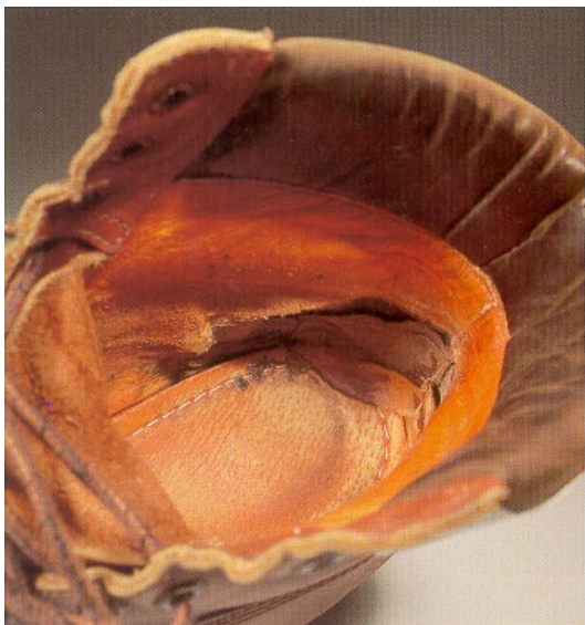
Godkendt reklamation. For tidlig nedbrydelse af for. Denne reklamation kan ikke laves.
