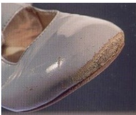
Afvist reklamation, pga. slitage. Skoen er blevet slidt, da den er blevet slæbt efter brugeren.
