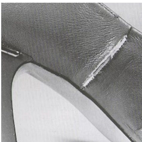
Godkendt reklamation. Syning har siddet for yderligt og har medført, at skindet er skredet. Kan repareres af en dygtig skomager.
